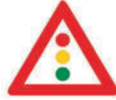
(K - 21) Προσοχή, κόμβος ή θέση όπου η κυκλοφορία ρυθμίζεται με τρίχρωμη φωτεινή σημα- τοδότηση.
